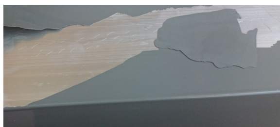
Abb. 1.1.5 Konversionsschicht zu dick
