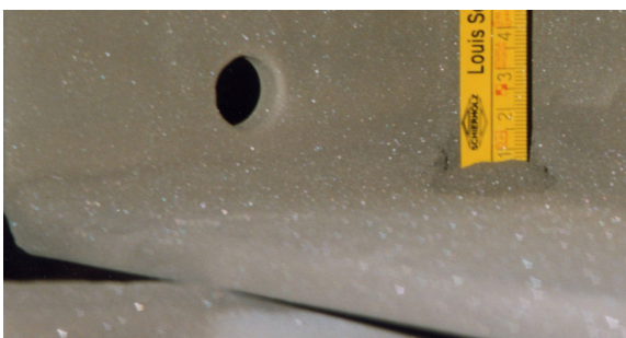
Abb. 2.3.5 Zu hohe Pulverschicht
