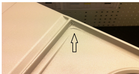
Abb. 3.7.2 Pulverlackhäufungen in Ecken durch abrieselndes
