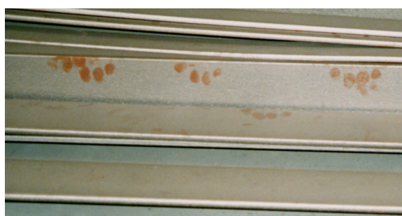
Abb. 3.2.6 Fingerprint mit Handcreme
