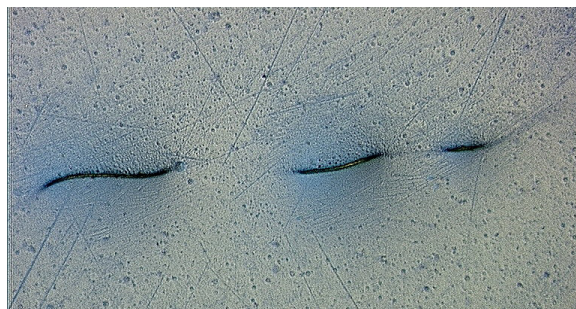
Abb. 3.5.2 Fasern, Flusen von Reinigungstüchern und Arbeitskleidung
