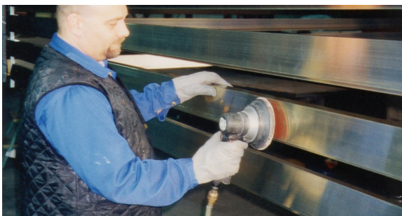
Abb.3.5.1 Verunreinigung der Lackoberfläche durch Schleifarbeiten
