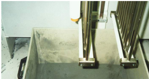
Abb. 2.1.1 Fluidisierung – Pulver muss wie Wasser fließen
