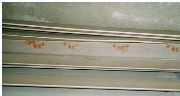
Abb. 3.8.2 Kontaminierung durch Handschweiß, verschmutzte Handschuhe, Handcreme usw.
