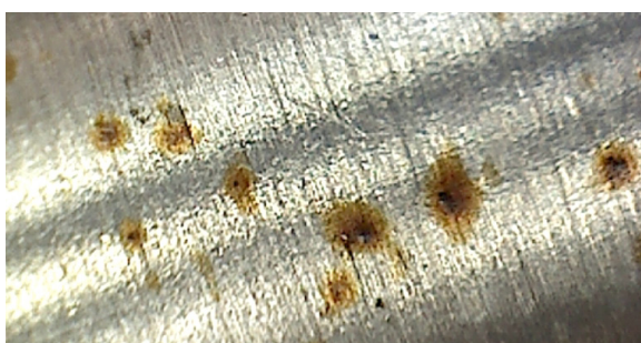
Abb. 3.2.3 Rost auf den Werkstücken
