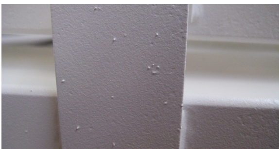
Abb. 3.1.3 Pulverspucker durch Ablagerungen an den Pistolen
