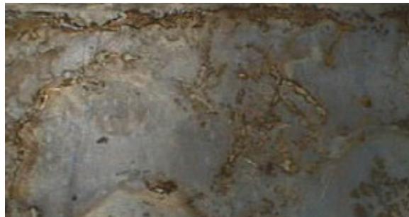
Abb. 1.3.4 Schlechte Spülung, anschließend nass gelagert
