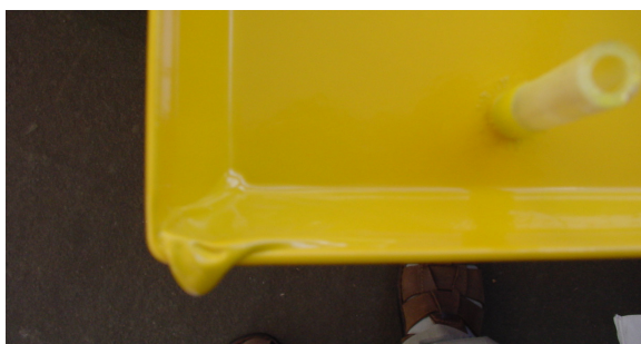
Abb. 3.7.1 Zu hohe Schichtdicke
