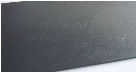
Abb. 3.2.7 Schlechte Spülung gestrahlt, KTL-grundiert
