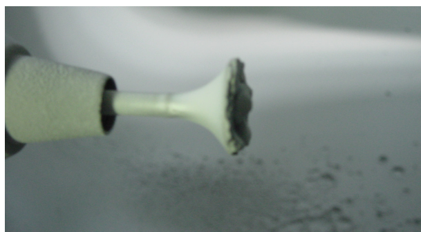
Abb. 2.2.2 Ansinterung an Pralltellerdüse
